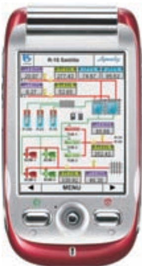
Sistema de monitoramento de processo da SABESP em aparelho celular
